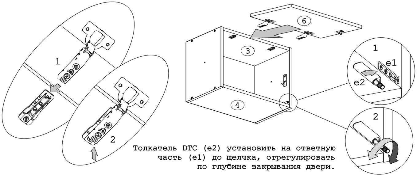
Толкатель DTC (e2) установить на ответную часть (e1) до щелчка, отрегулировать по глубине закрывания двери.
