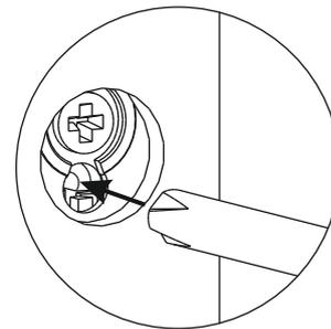
**Внимание!** После регулировки навесов (г, д), отверстия в дет. №5 закрыть загл. самокл. Д25 (з).
