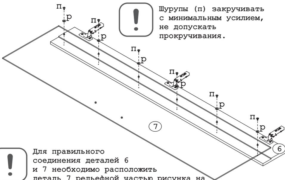
Шурупы (п) закручивать с минимальным усилием, не допускать прокручивания.
