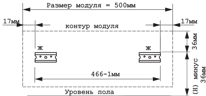
После монтажа корпуса на стену отрегулировать изделие по высоте и прижать к стене с помощью регулировочных винтов.
