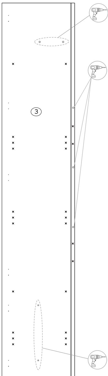
Досверлить отверстия  $\varnothing 8\text{мм}$
